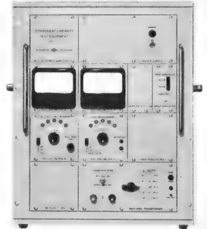
Bild 2. Ansicht des Linearitäts-Meßgerätes für Bauelemente der Firma Radiometer
