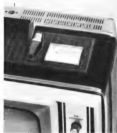
Bild 8. Grundig-Portable P 1600 als Antennenmeß- und Prüfgerät mit eingebautem Spannungsmesser
