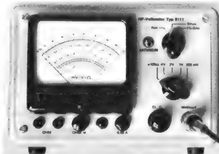
Bild 4. Hf-Voltmeter für Antennenmessungen (Kathrein)
