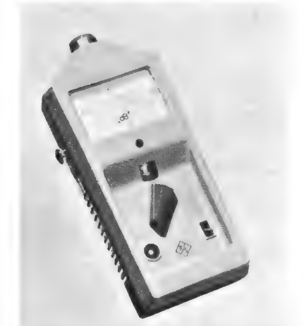
Bild 14. Zur Präzisionsklasse gehört der kleine Schallpegelmessgerät ELT von Rohde & Schwarz, der nur 650 g wiegt
