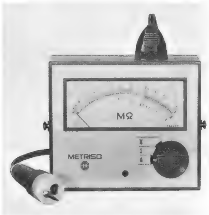
Bild 13. Der Isolationsmesser Metriso von Metrawatt arbeitet mit 600 V Meßgleichspannung, die von einem Gleichspannungswandler erzeugt wird
